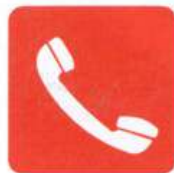
Teléfono para la lucha contra incendios
